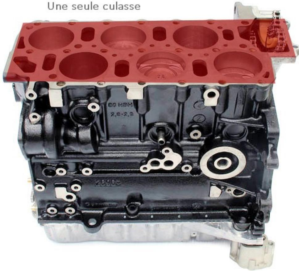
Les VR sont des moteurs en V dont l'angle a été réduit pour réduire l'encombrement du moteur. Le meilleur exemple reste celui de la Golf 3 VR6 qui n'avait pas forcément énormément de place sous son capot. Les pistons sont si rapprochés qu'il n'y a pas besoin d'avoir deux culasses (une pour chaque rangée dans le cas des V6). Il a donc pu être placé de manière transversale dans la Golf sachant qu'elle reste une des rares compactes du marché à avoir accueilli un 6 cylindres.
